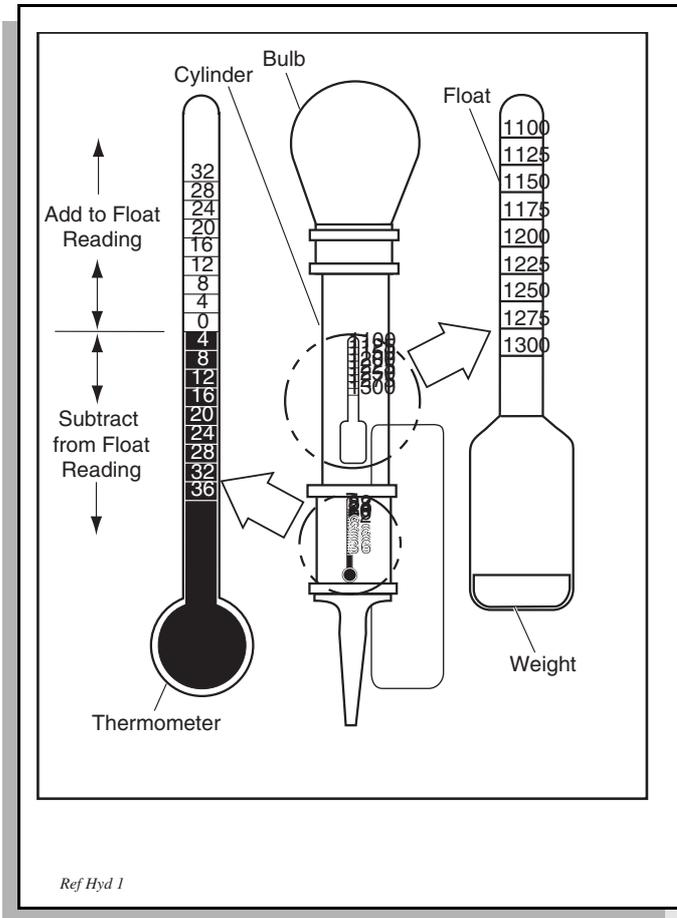
Fig. 30 Hydrometer
