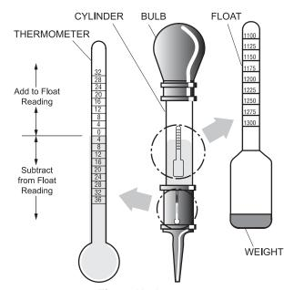
Fig. 7 Hydrometer
