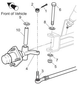
Fig. 16 Spindle Replacement
